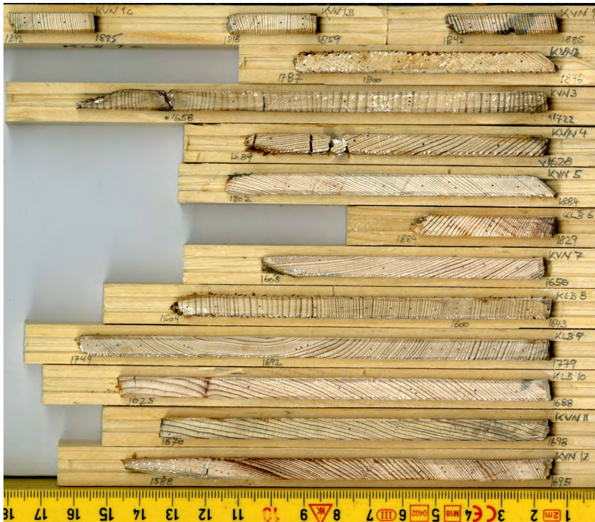
Figur 8: Boreprøvene. Tiårene, femtiårene og århundrene merket med hhv. 1, 2 og 3 blyantprikker.
