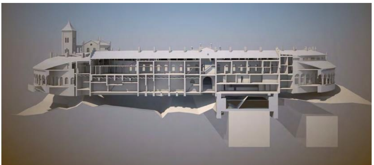
Figur 34: Snitt av bygningen med de to tunnel-løpene, NSB til venstre (Illustrasjon: Arkitektskap).
