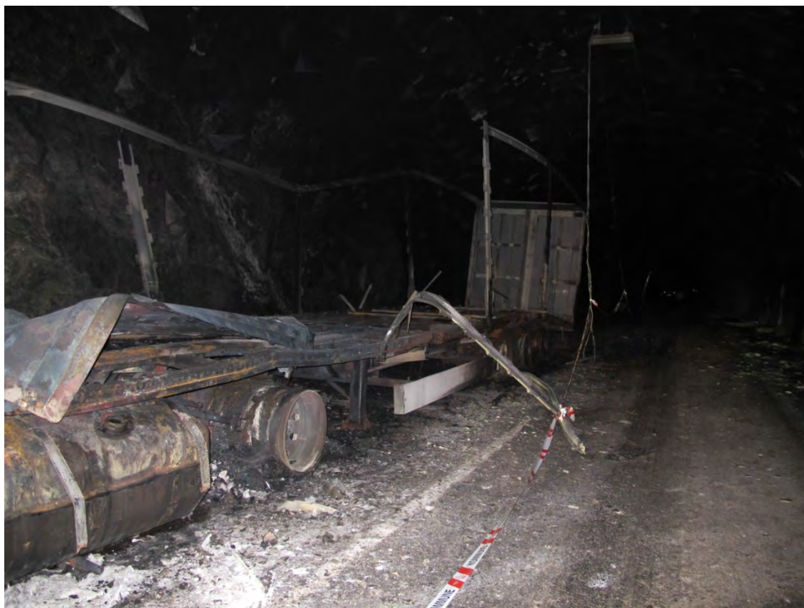
Figur 2-3 Bildet viser den utbrente semitraileren. Foto: SHT.
